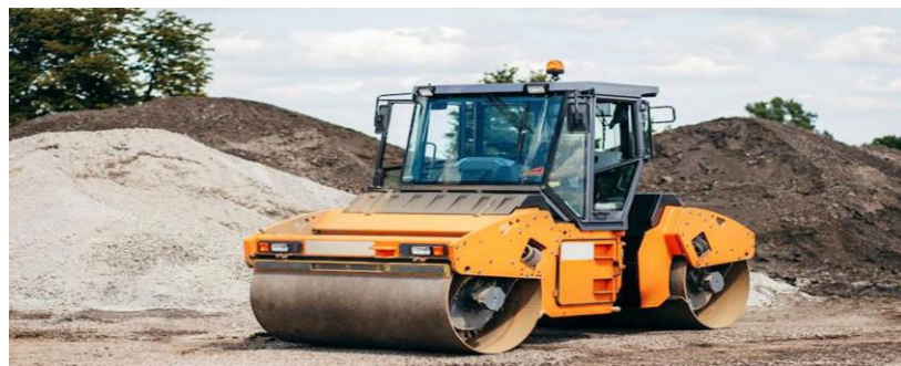
Fig 2 : Smooth wheel Roller (sources :civilengpro.com)
